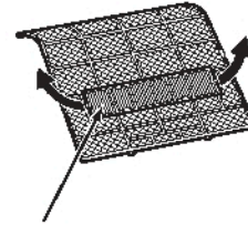
แผ่นกรองฟอกอากาศ (ชนิดแผ่นใยรูปคลื่นสี่ฟ้า)
